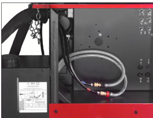
Fig.22 Montagem dos cabos e dos conectores
