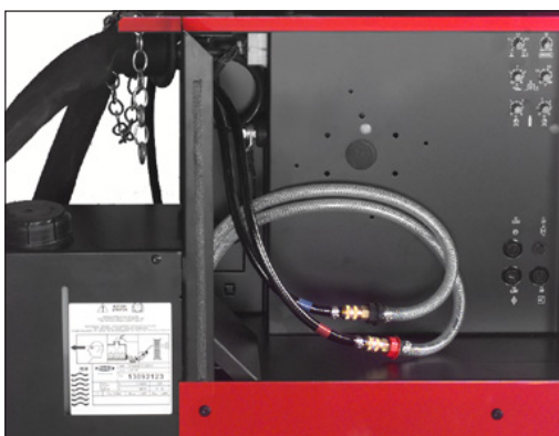
Ilustr. 22 Montaje de los cables y de las conexiones
