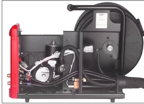
Fig.23 Montagem do jogo de mangueiras de ligação no avanço de arame VR 3000
