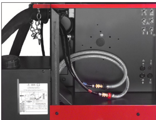
Fig.22 Montaggio dei cavi e dei collegamenti
