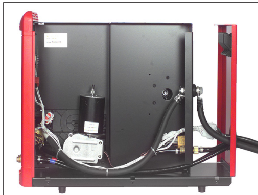
Fig.24 Montagem do jogo de mangueiras de ligação no avanço de arame VR 3300
